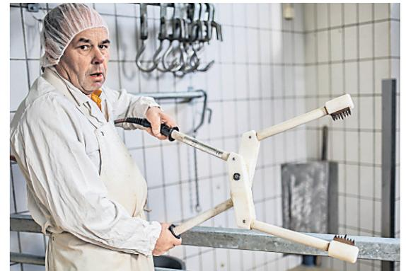
**Nach der Betäubung per Elektrozange (oben) in Sekunden-schnelle kommen die Schweine in den modernen Schlachtraum mit Förder-schiene**
